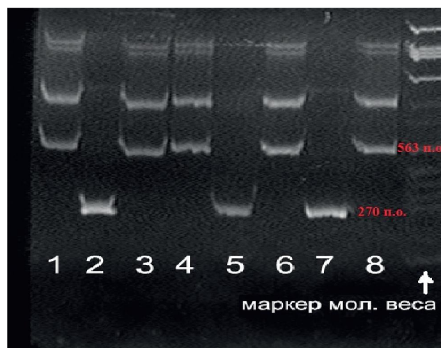
Рис. 1. Идентификация гена устойчивости к пирикулярриозу Pi-ta с помощью ПЦР-анализа; 1 – сорт Флагман (материнская форма), 2 – сорт-донор IR-36 (отцовская форма), 3–8 – гибридные растения F 2 BC 3 , маркер мол. веса – маркер молекулярного веса pBR322/BsuRI. Указаны размеры диагностических фрагментов гена устойчивости
